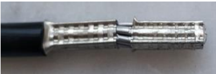
Рисунок А4 – Пример обжатия многожильного провода типа СИП
