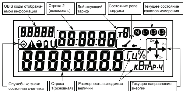
Рисунок 5 – Внешний вид ЖК индикатора устройства СЕ901
