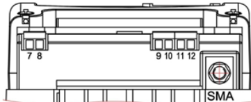
обозначение контактов счетчика с радиомодулями, с внешней антенной
