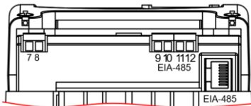
обозначение контактов счетчика с Ethernet модулем
