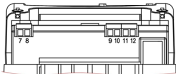
обозначение контактов счетчика с интерфейсом EIA-485
